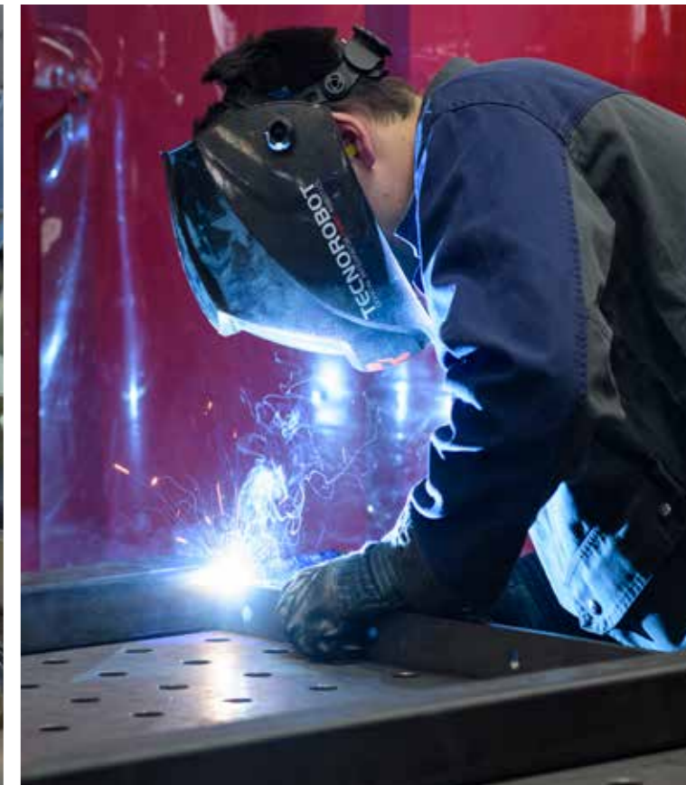
Soudage L'aide-constructeur métallique assemble les profilés et les tôles au moyen de différents procédés de soudage.
